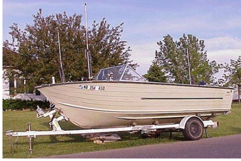
Alt yapısı kayıcı tip olan bir tekne
